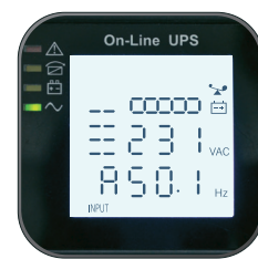
Контрольная панель силового модуля
