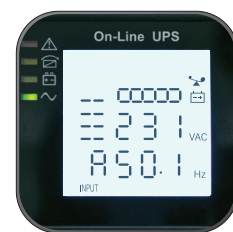
Контрольная панель силового модуля
