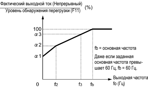
Характеристики охлаждения двигателя со встроенным самоохладжающим вентилятором
