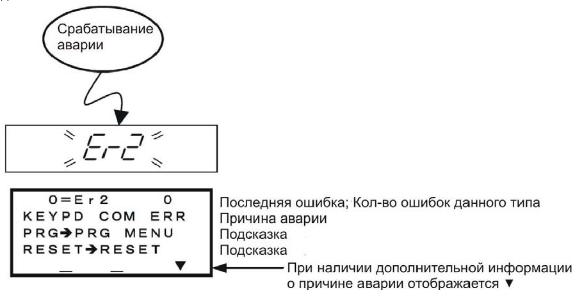
Рис. 3.38 Индикация без перекрывающейся аварии
