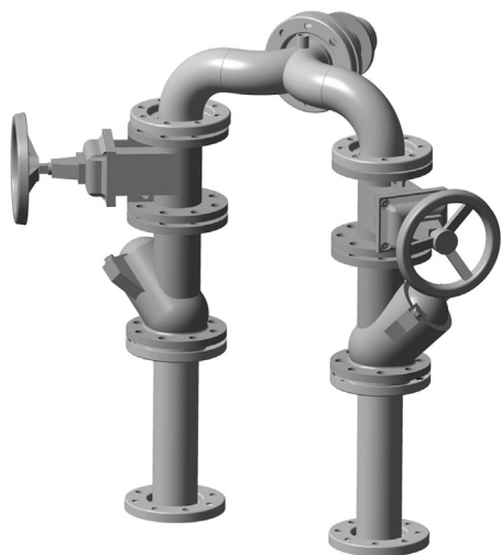
Рис. 6 DC, обвязка с общим прямым выпускным патрубком
