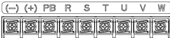
Рис 4.10 Клеммы силовых цепей ПЧ 030G/037P–037G/045P
